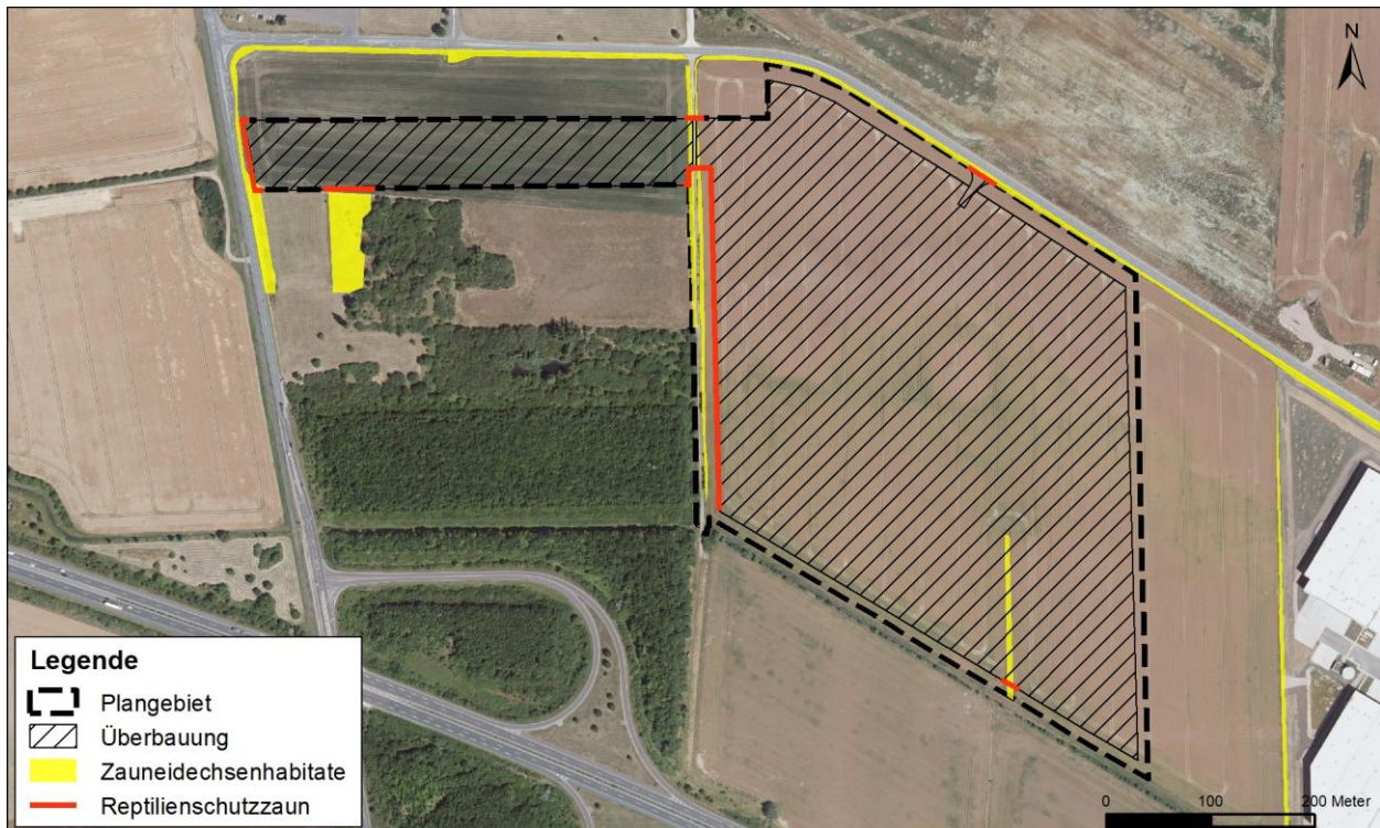
Abbildung 2: Lage der Reptilienschutzzäune bei Bauarbeiten während der Aktivitätszeit (DOP20 © GeoBasis-DE/LVermGeo ST)
