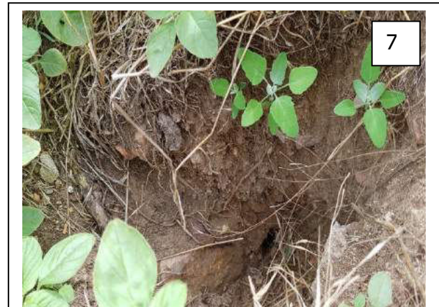
Spatenprobe Obere Bodenschicht mit sandig-humosen, aber auch steinigen Ablagerungen.
