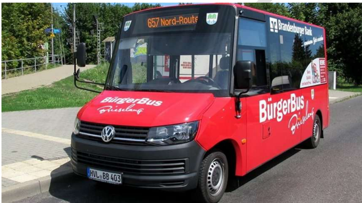
Abbildung 40 Ein Bürgerbus in Brieselang. Das Fahrzeug ist der Umbau eines handelsüblichen Kleinbusses. Bild: VBB.
